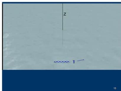
*En el momento que se lanzaba al agua en posición horizontal, con la hélice en marcha, el móvil mantenía esta posición horizontal en el agua, rotando sobre su eje longitudinal impulsado por su hélice, e iniciaba una trayectoria curva que evidenciaba que las hipótesis teóricas se cumplían. El móvil describía exactamente el tipo de trayectoria prevista en la simulación por ordenador (3 0 Submarino simulación:*
